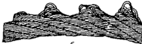
Рис. 12. Выдавливание проволок прядей:
