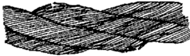
Рис. 1. Обрывы и смещения проволок каната крестовой свивки
